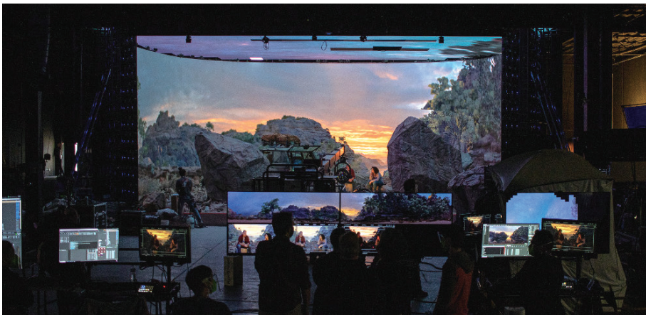
그림 2 Unreal Engine과 Epic Games로 광범위한 버추얼 프로덕션 스튜디오에서 IC-VFX 시스템 적용
